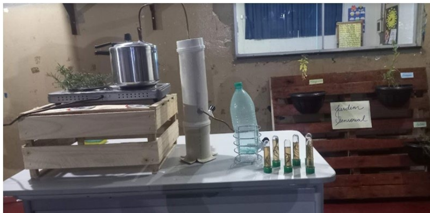
Figura 1- Extrator de Óleo Essencial desenvolvido pelos alunos da EJA
