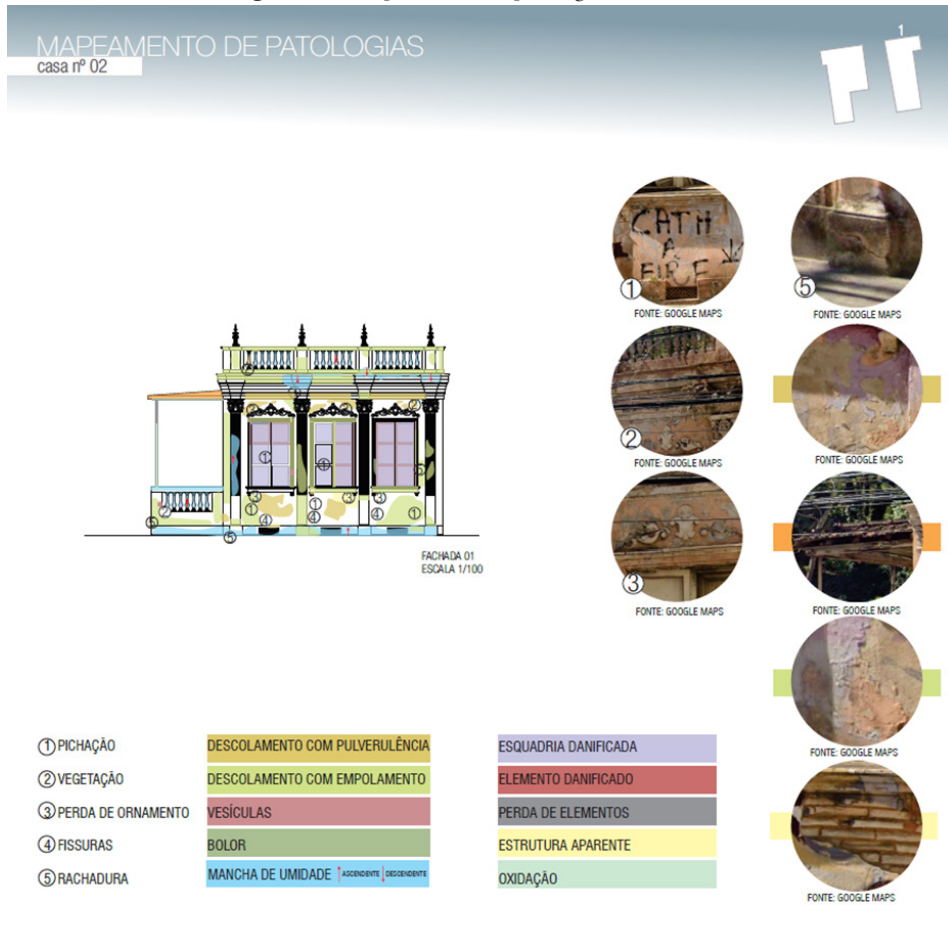
Figura 12 - Mapeamento de patologias da Casa 610
