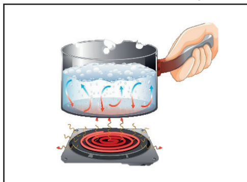
Figura 2 - Correntes de convecção criadas na água ao ser aquecida.
